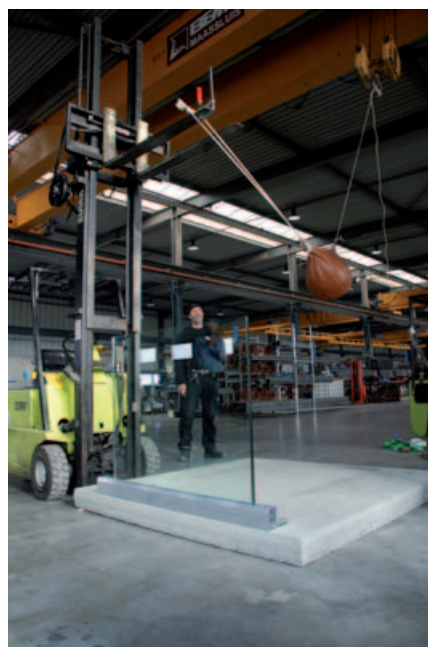
▲ Test van éézijdig ingeklemd 'conventioneel' gelamineerd balustradeglas.
