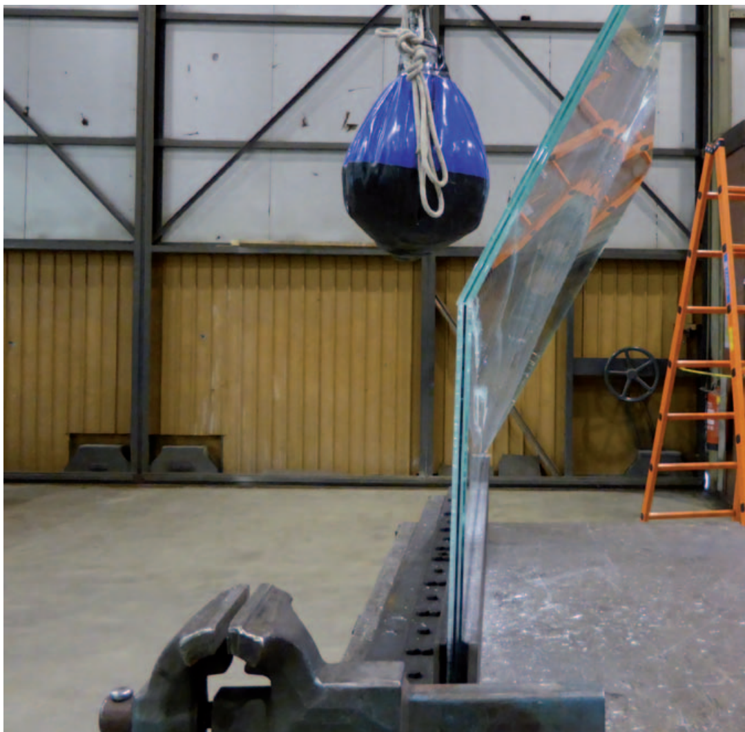
▲ Pas na het aanbrengen van een kras in het chemisch geharde glas leidde de test tot een glasbreuk.
