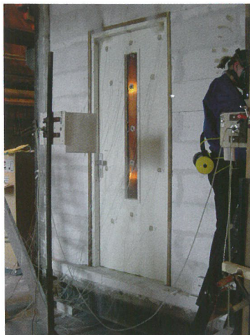
Brandwerendheidstest (Foto: Weekamp Deuren B.V.).
