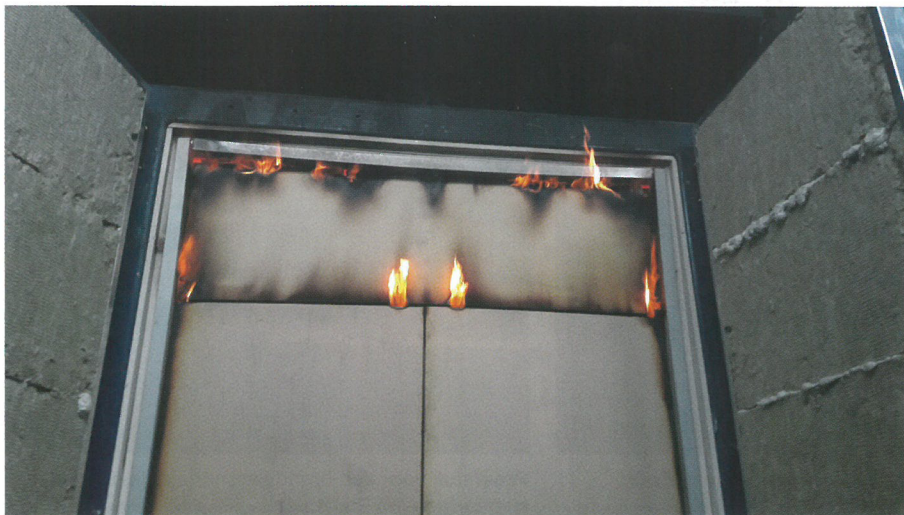
Brandproef van een 60+ dubbeldeurs met paneel erboven in een Avento-kozijn.
