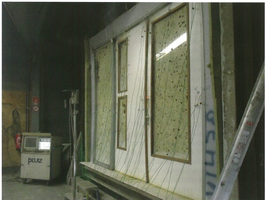
Brandwerendheidstest bij Peutz, met een deurstel van Van Vuuren.
