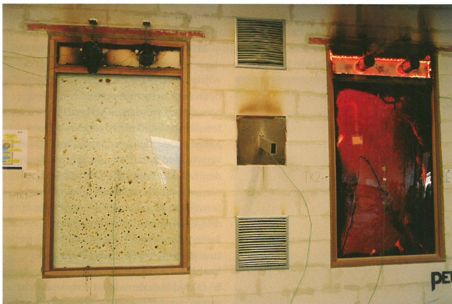
Brandwerendheidstest in het laboratorium van Peutz.
