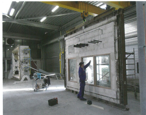
Proefstuk voor een brandwerendheidstest in het laboratorium van Peutz.
